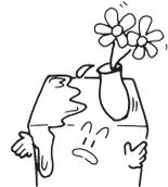
●こぼれた水で電気部品の絶縁が悪くなり漏電火災の恐れがあります。
